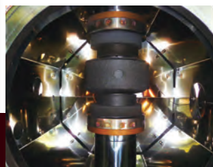
大口径真空チャンバー (大形焼結体作製用型セット時の写真)
