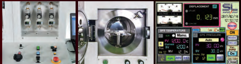
冷却水監視機能と パルスサーダイヤルを搭載
